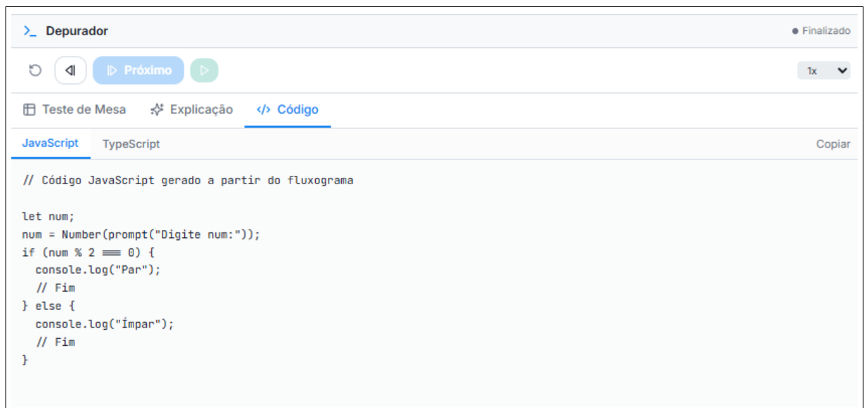
Figura 15 – Implementação em JavaScript do algoritmo SE composto (par ou ímpar), com comparação ao diagrama de blocos. Fonte: Elaborado pelo autor.
