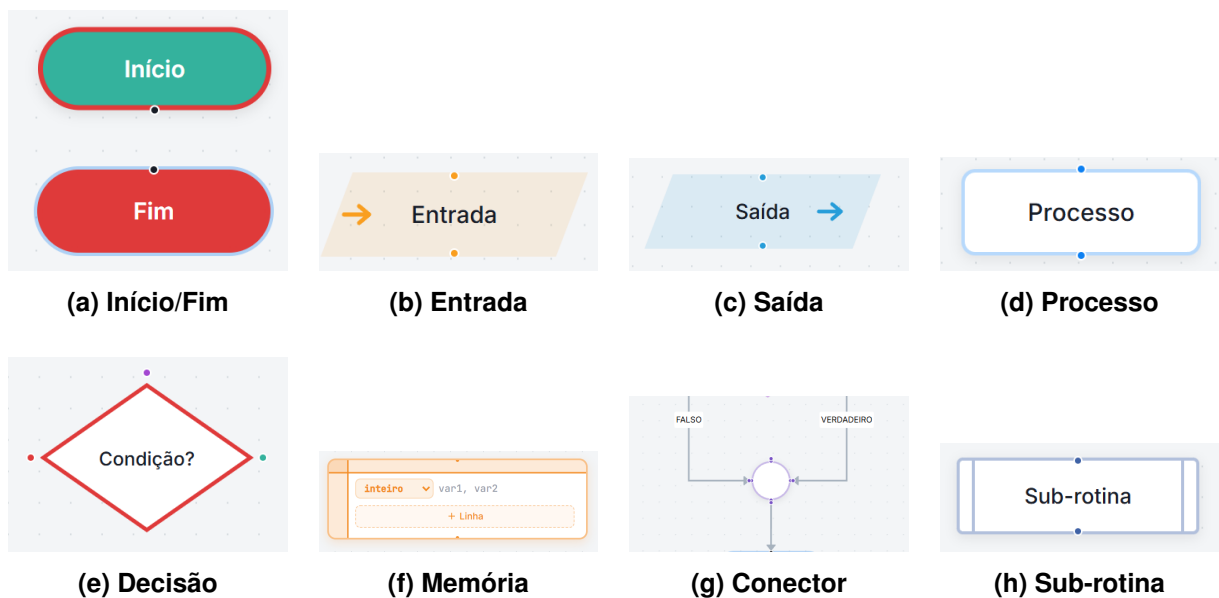
Figura 11 – Blocos implementados no protótipo do sistema Fonte: Elaborado pelo autor (2026).
