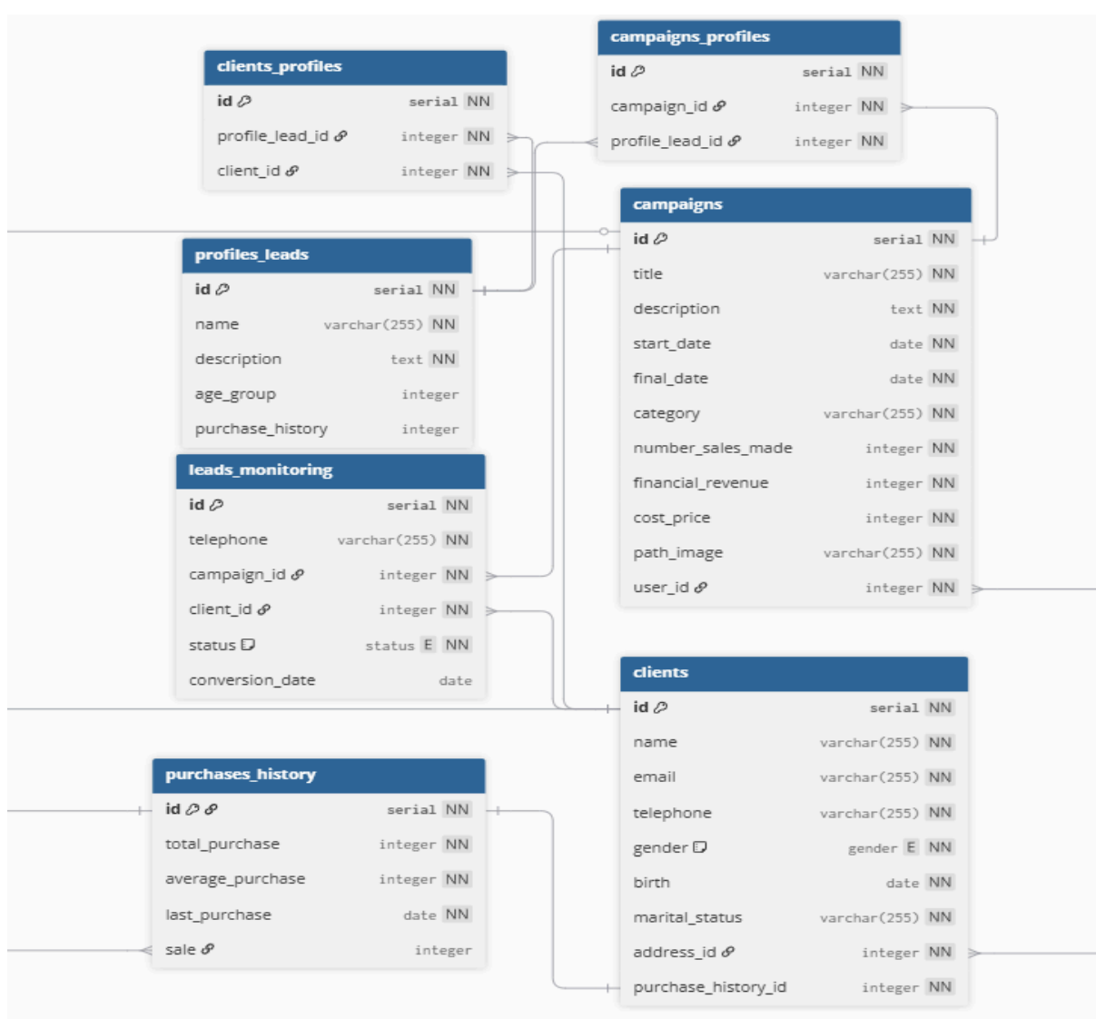
Figura 6 – Protótipo do modelo conceitual do BD desenvolvido no DrawDb.
