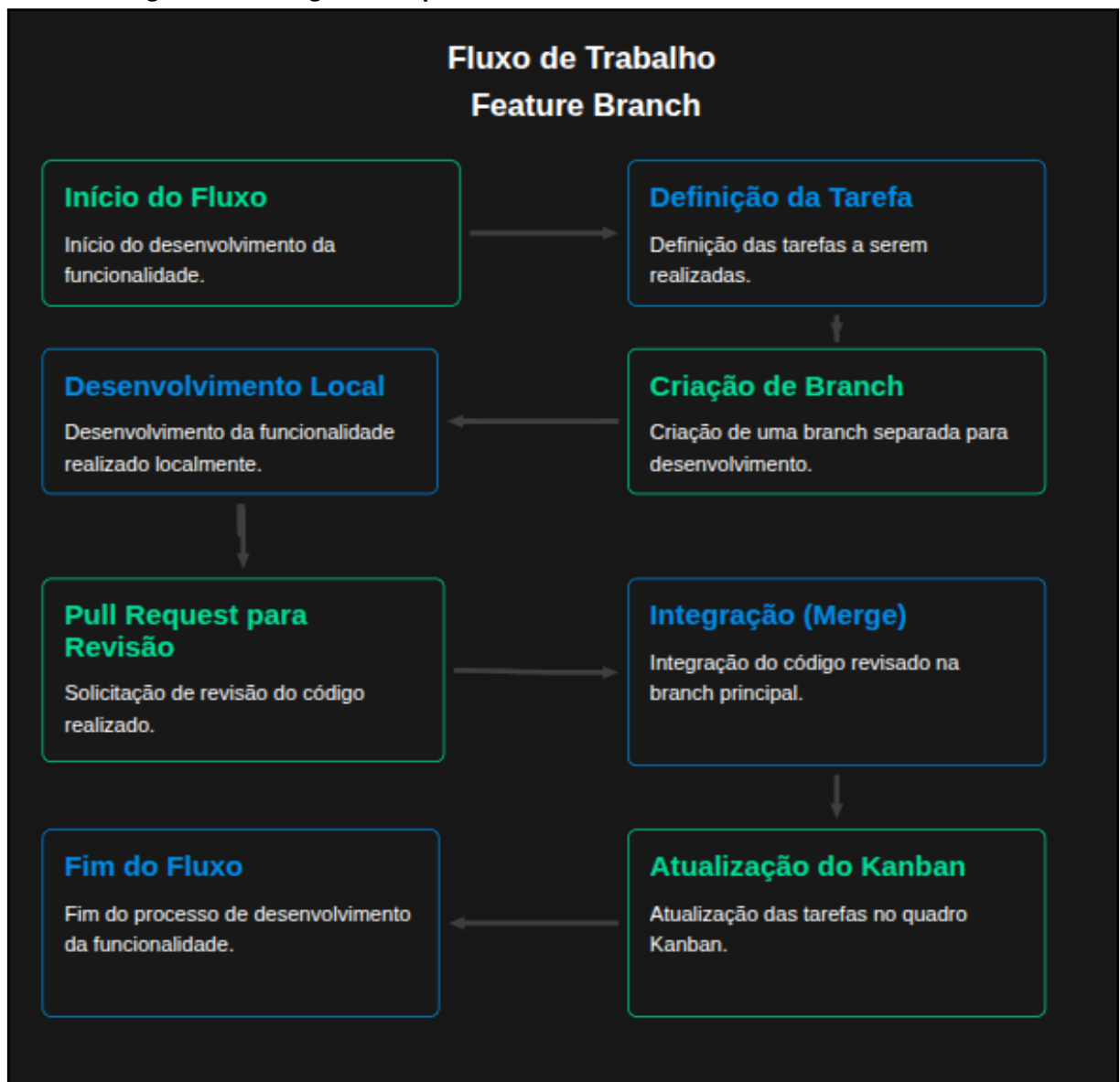
Figura 1 – Fluxograma do processo de desenvolvimento do módulo analítico
