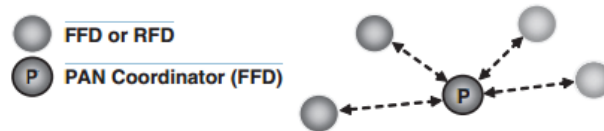
Figura 8: Exemplo de topologia estrela
