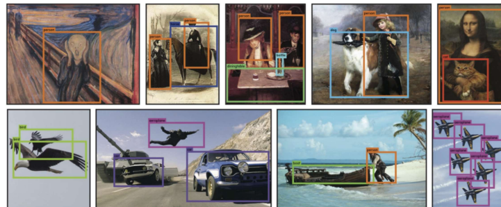
Figura 6 – Exemplo de detecção de objetos com YOLO
