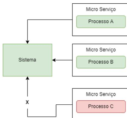
Figura 10 – Exemplo de um sistema baseado em microsserviços
